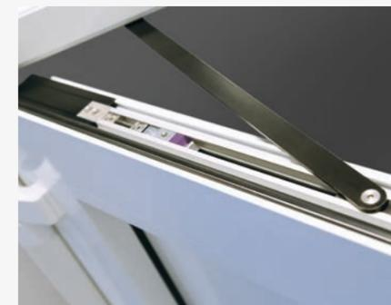
Verdeckter Öffnungsbegrenzer - Standard bei BFD, optional bei GF und FD Der Öffnungsbegrenzer wird verdeckt liegend verbaut bei einer Mindestflügelbreite von 830 mm. Er besitzt eine Rastfeststellung mit Endschlagdämpfung, zusätzlich ist die Haltekraft und der Öffnungswinkel bis zu 115° einstellbar.
