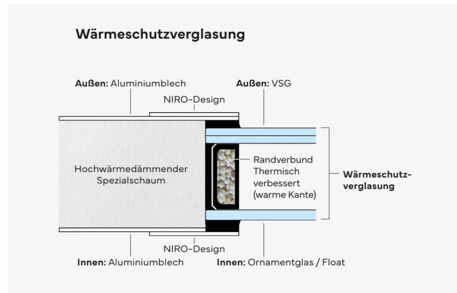
Jeweils ein Glashalterahmen in Niro-Design fasst die Wärmeschutzverglasung innen und außen ein. Die Abdichtung mit Silikon sorgt für zusätzliche Dichtheit.
