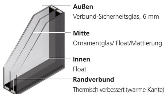
**3-fach-Verglasung =  $U_g$  0,6  $\text{W}/(\text{m}^2\text{K})$**
