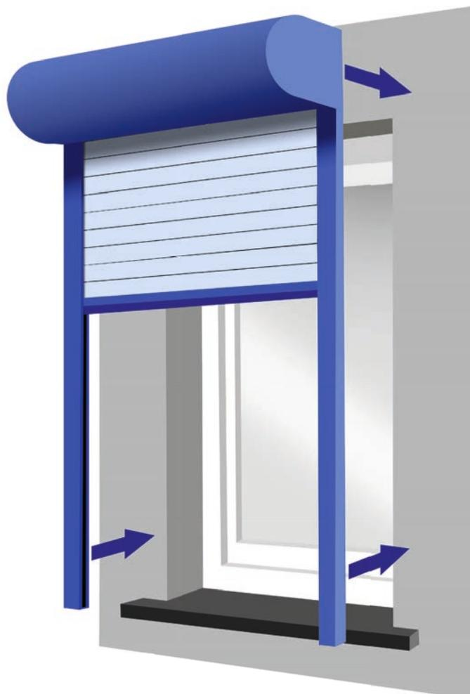
*Das Prinzip: Vorbaurollläden werden auf die Fassade gesetzt oder in die Leibung montiert.*
